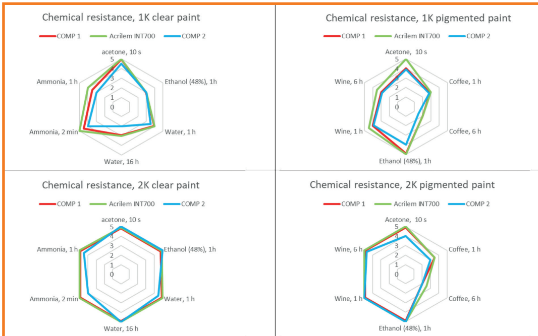
Fig. 2 Chemical resistance of clear and pigmented coatings, 1K (top) and 2K (bottom) versions Resistenza chimica dei rivestimenti trasparenti e pigmentati, varianti 1K (in alto) e 2K (in basso)
