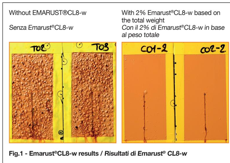
**Fig.1 - Emarust®CL8-w results / Risultati di Emarust® CL8-w**
