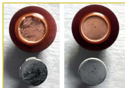
Fig. 3 - Examples of failure patterns: left: combination of adhesive and cohesive failure; right: almost solely adhesive failure (study B) Esempi di modelli di degradazione: a sinistra, combinazione di degradazione coesiva e adesiva; a destra, principalmente solo degradazione adesiva (studio B)
