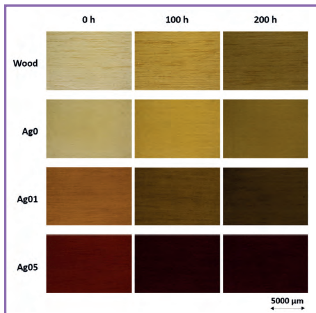
Fig. 2 Evolution of the appearance of the samples during exposure to UV-B radiation. With permission from Elsevier [1] Evoluzione dell'aspetto dei campioni durante l'esposizione alla radiazione UV-B. Con il permesso di Elsevier [1]
